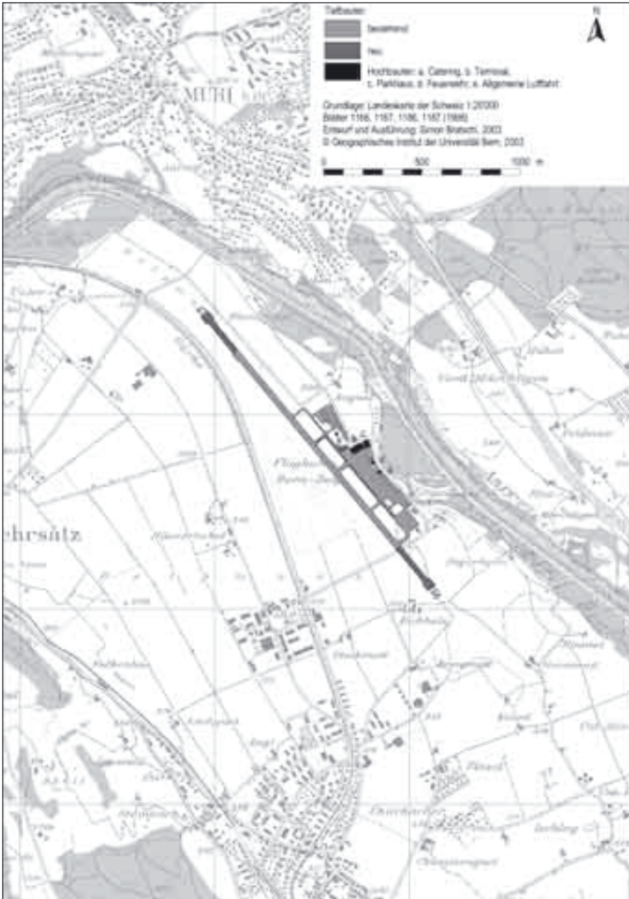
Abb. 10 Flughafen Bern-Belp, Masterplan 1998–2005. Dieses Projekt umfasst eine Pistenverlängerung in beide Richtungen. Eine Verlängerung ausschliesslich in südöstliche Richtung wäre angesichts des nahen Waldes im Nordwesten vorteilhafter, der Landerwerb wäre aber bedeutend aufwändiger und kostspieliger gewesen. Der neue Terminal bringt für die Passagiere erheblich mehr Komfort.
