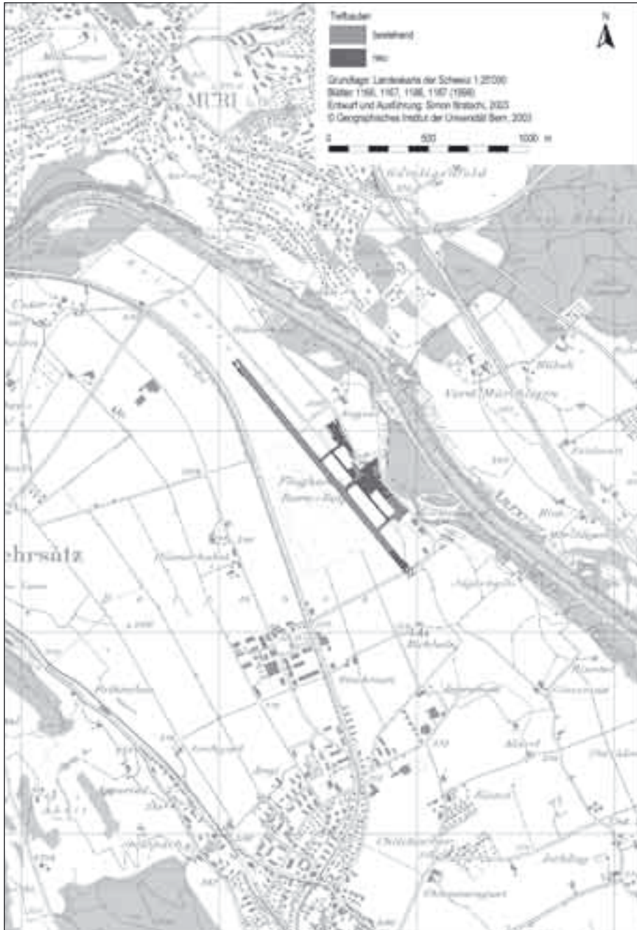
Abb. 8 Flughafen Bern-Belp, Ausbau von 1965. Mehr Flickwerk denn Ausbau: Dieses Projekt brachte eine etwas längere Startstrecke, ein paar zusätzliche Flugzeugstandplätze und zwei Wendebuchten, um die Fahrwerke beim Wenden auf der schmalen Piste zu schonen. Eine Pistenbeleuchtung ermöglichte erstmals tageslichtunabhängigen Verkehr.
