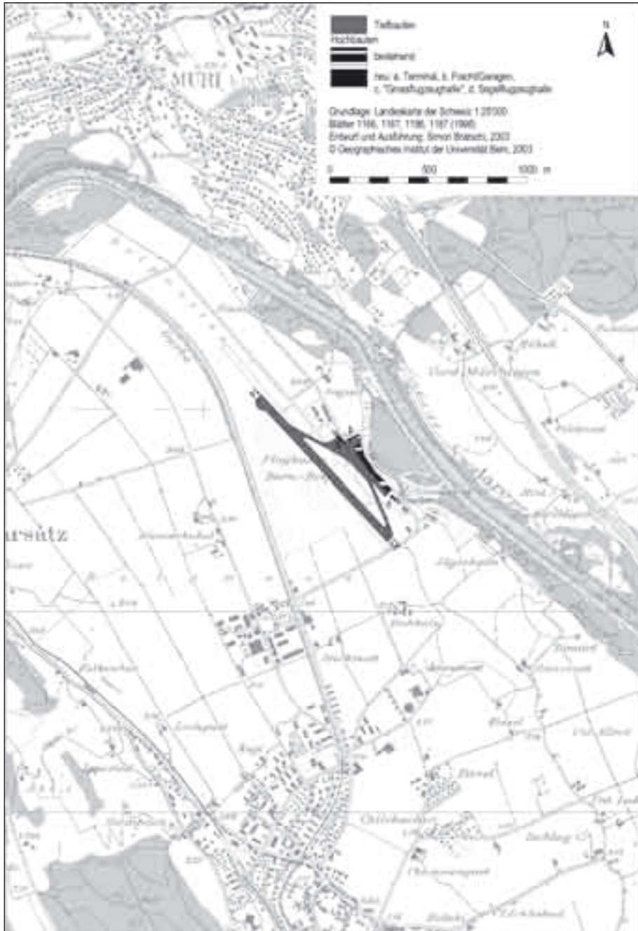
Abb. 6 Flughafen Bern-Belp, Ausbauprojekt von 1947. Die kurze Piste ist gegenüber der heutigen leicht abgedreht. Der südöstliche An- und Abflugsektor wäre damit etwas weiter vom Belpberg entfernt, allerdings wäre eine Pistenverlängerung in nordwestliche Richtung wegen des nahen Gürbedamms praktisch unmöglich gewesen.
