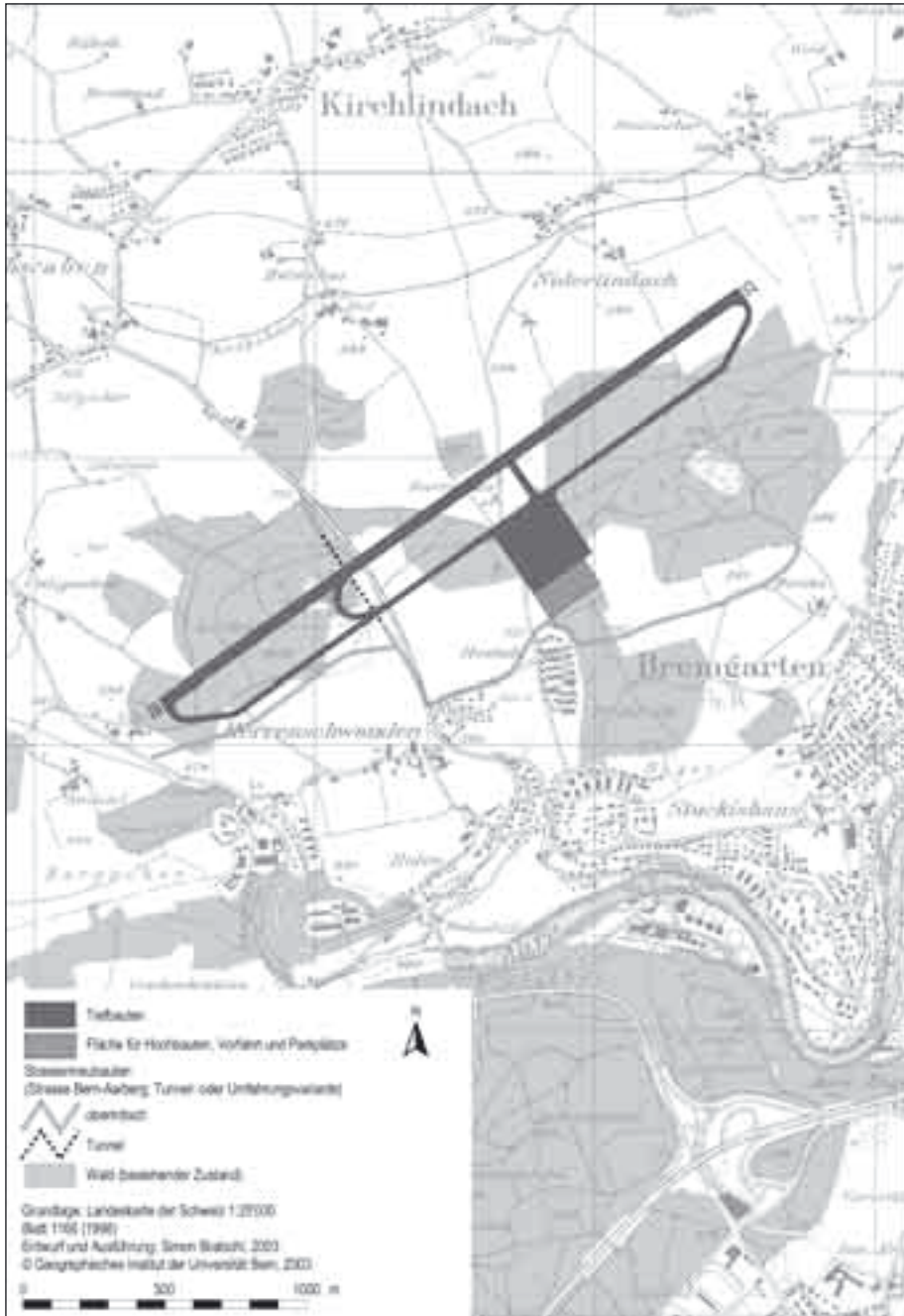
Abb. 3 Neubauprojekt Bern-Nord (Herrenschwanden), 1952–1963. Um den Verbrauch von landwirtschaftlicher Nutzfläche zu minimieren, sollte dieser Flughafen in ein Gelände zu liegen kommen, das mit grossem Aufwand gerodet und planiert werden musste. Flugtechnisch vorteilhaft war die erhöhte Lage gegenüber der näheren Umgebung.
